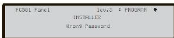
Slika 38 Pogrešan instalaterski kod
