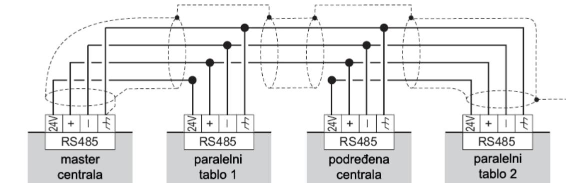
**Slika 12** Primer RS485 povezivanja: napajanje paralelnih tablova se deli na nekoliko centrala: paralelni tablo 1 se napaja sa master centrala, a paralelni tablo 2 se napaja sa podređene centrale
