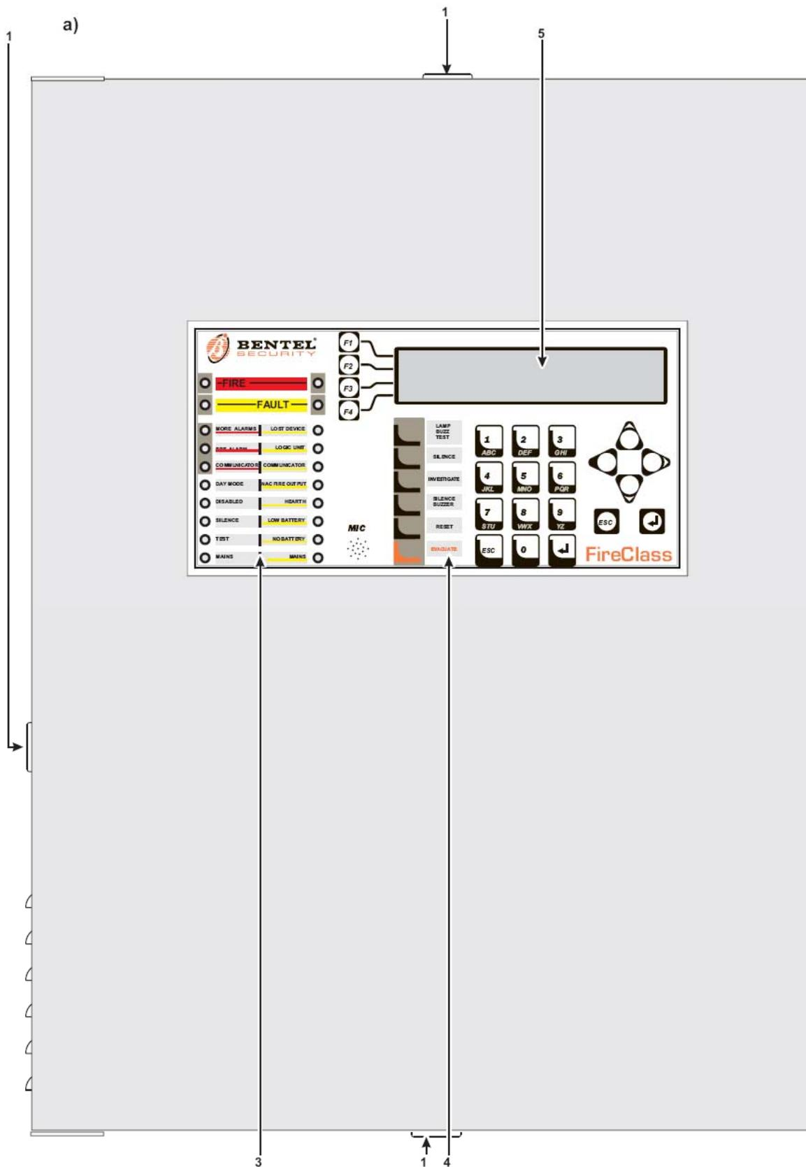
Slika 1 Izgled FC510 i FC520 centrale (a) i FC500REP paralelnog tabloa (b)
