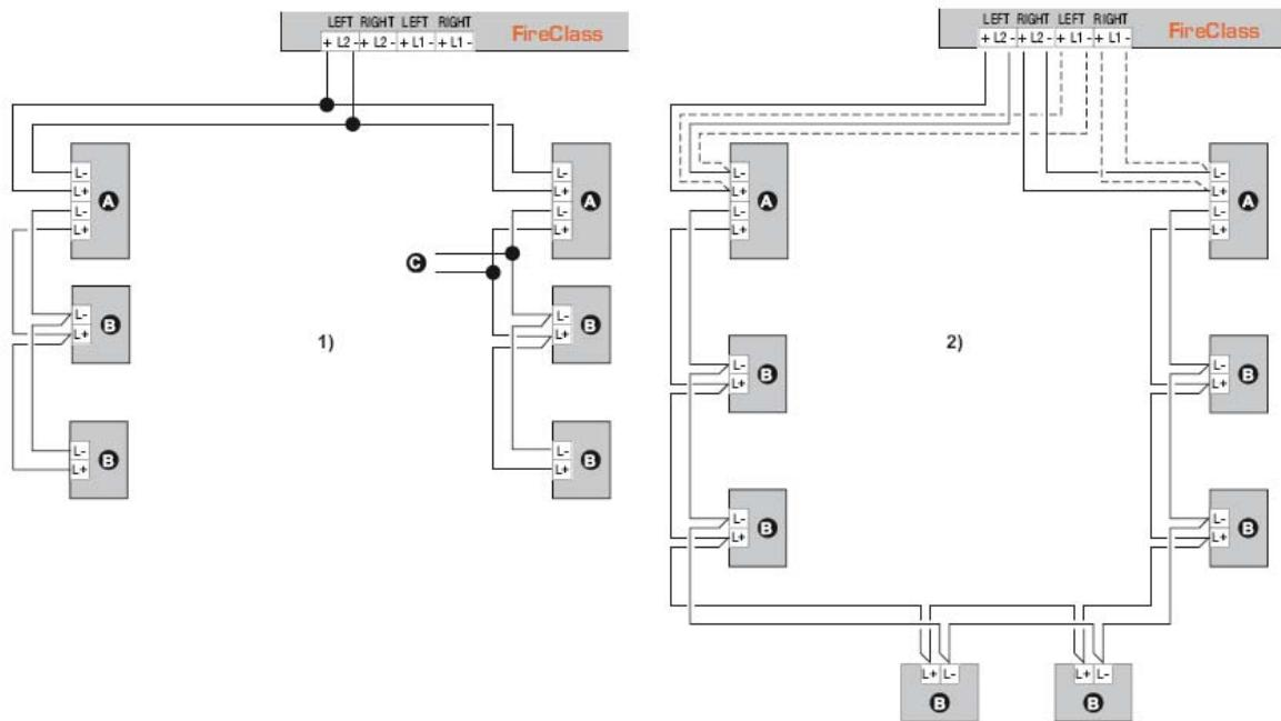
**Slika 9** 1) Povezivanje sa 2 žice - 2) povezivanje sa 4 žice: a) izolatori; b) kompatibilni analogni uređaji (požarni detektori, ulazni moduli, izlazni moduli, moduli konvencionalne zone, ručni javljač); c) T konekcija
