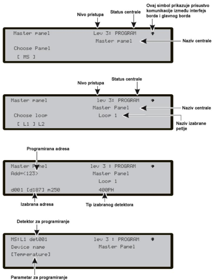
**Slika 43** Izbor i programiranje uređaja na petlji
