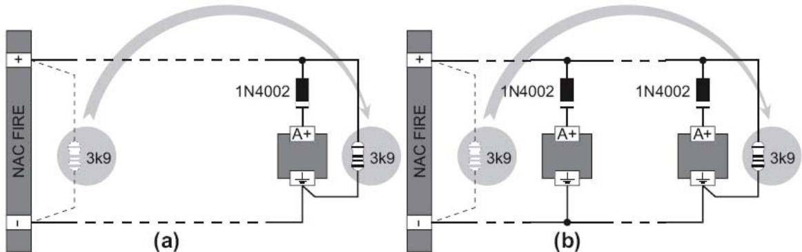
**Slika 13** Povezivanje jednog uređaja (a) ili više uređaja (b) na izlaze za signalizaciju (uređaji koji se aktiviraju sa +27.6V na kontaktu [A+])
