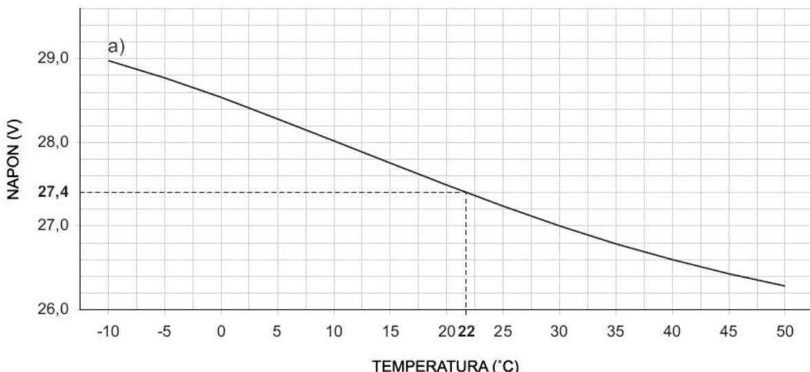
**Slika 17** Dijagram izlaznog napona čoperskog napajanja. Određivanje izlaznog napona: - označiti temperaturu senzora na osi TEMPERATURA; povući liniju od vrednosti temperature do krive a); povući liniju od mesta preseka do ose NAPON; podešiti izlazni napon čoperskog napajanja na rezultantnu vrednost. Na primer, ako je temperatura senzora 22°C, izlazni napon čoperskog napajanja se mora podešiti na 27.4V.
