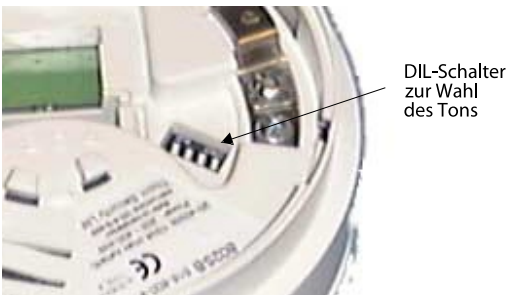
Abb. 4: DIL-Schalter zur Wahl des Tons
