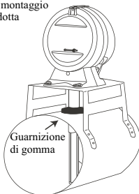
FIG. 9 Installazione della staffa per sonda da condotta sui condotti circolari o rettangolari isolati.
